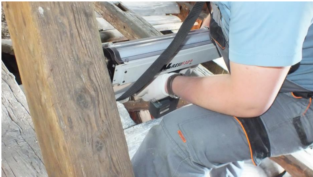
Ryc. 4 Fotografia przykładowego badania rezystografem oporowym
