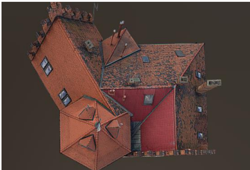
Ryc. 7 Widok 3D pokrycia dachowego (fotogrametria)
