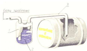
Rys. 7 Cięte lub spawane pojemniki, mogące zawierać gazy lub pary cieczy palnych, należy przed przystąpieniem do prac wypełnić gazem obojętnym, np. gazami spalinowymi z silnika samochodowego podawanymi przez łapaczkę iskiei: 1 – łapaczka iskiei, 2 – woda, 3 – przewód doprowadzający gazy do wnętrza pojemnika.
