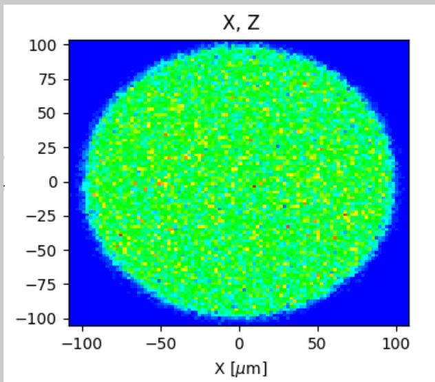
167  $\mu\text{m}$  x 159  $\mu\text{m}$  (full width!)
