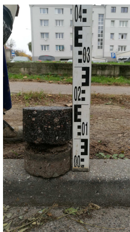
Fot. 1. Rdzeń pobrany z nawierzchni drogowej w otworze nr 1.
