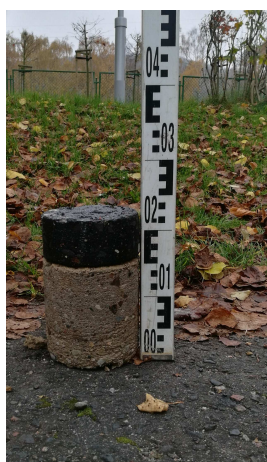
Fot. 3. Rdzeń pobrany z nawierzchni drogowej w otworze nr 4.
